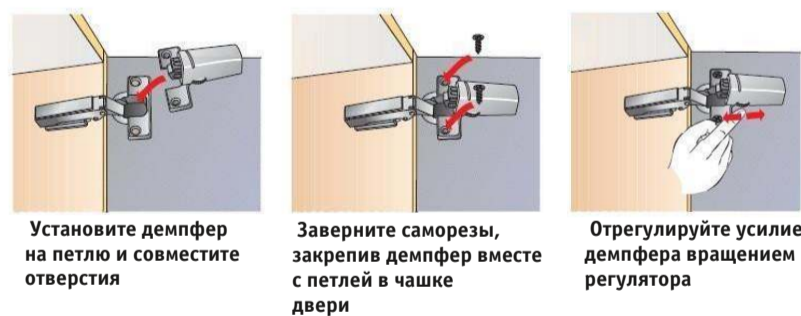
Рис. 5. Установка демпфера в чашу петель.
