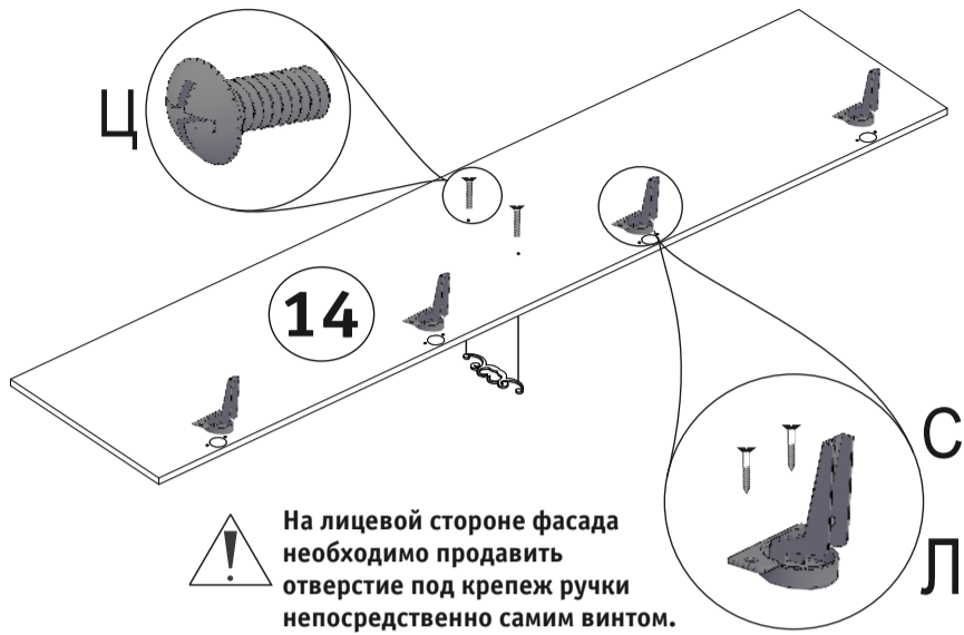
Рис. 5. Установка петель на фасаде.
