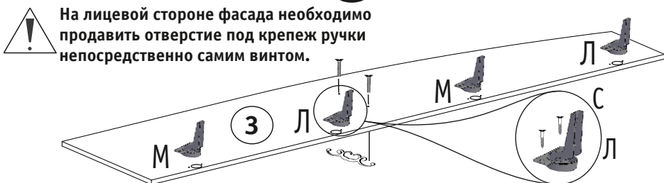
Рис. 6. Установка петель на фасадах.
