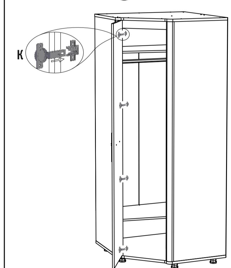
Рис. 5. Установка фасадов.
