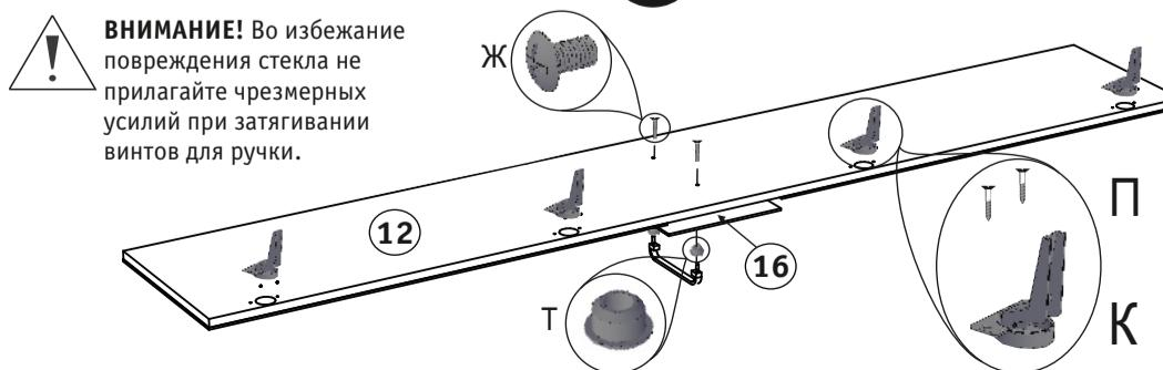
Рис. 3. Установка петель на фасадах.
