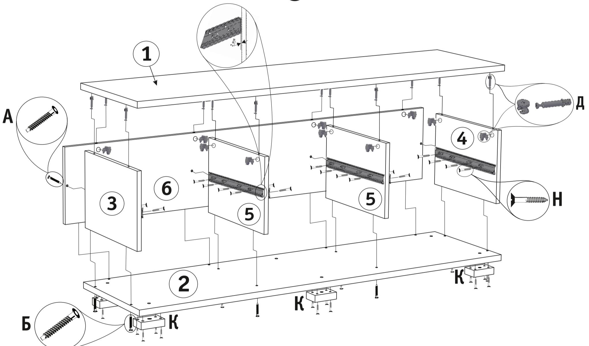
Рис. 2. Сборка каркаса.
