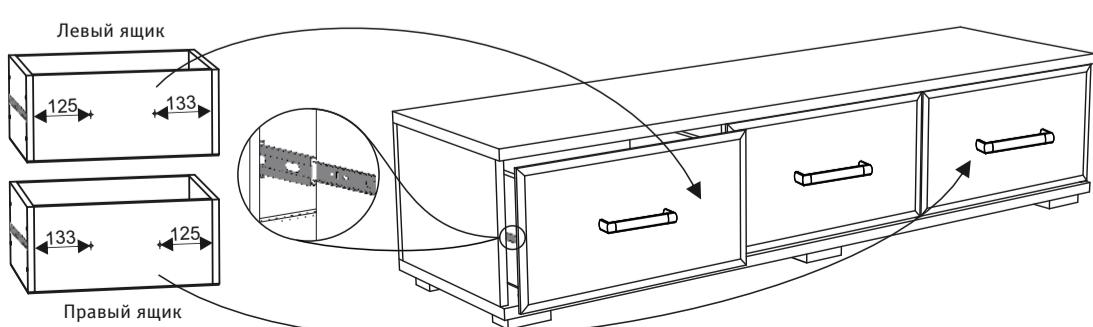
Рис. 3. Установка ящиков.
